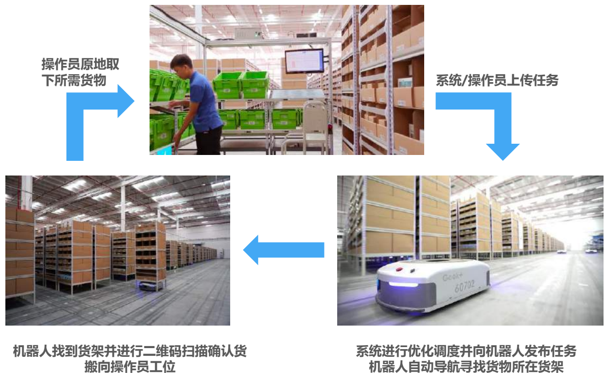
图示：Geek+仓储移动机器人机协作流程
